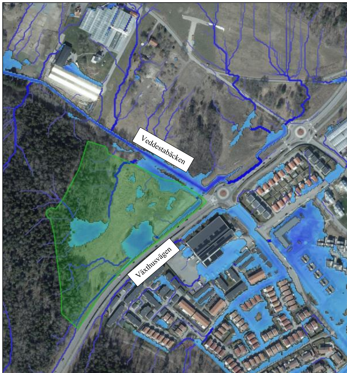
Figur 3-3. Flödesriktningar och lågpunktsområden inom planområdet enligt befintlig markanvändning. Bild från Scalgo Live.
